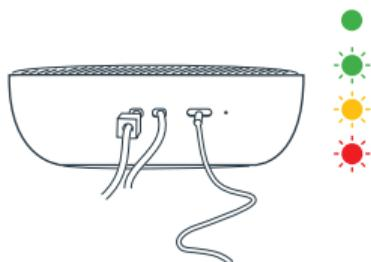
Verbinden Sie beim Aufladen das USB-C-Kabel mit dem USB-NetzadAPTER oder schließen Sie das Kabel direkt an den Computer an. Die Batterieanzeige zeigt dabei den Energiestatus an.
