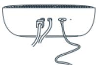
USB-C接続ケーブルを挿入します。
